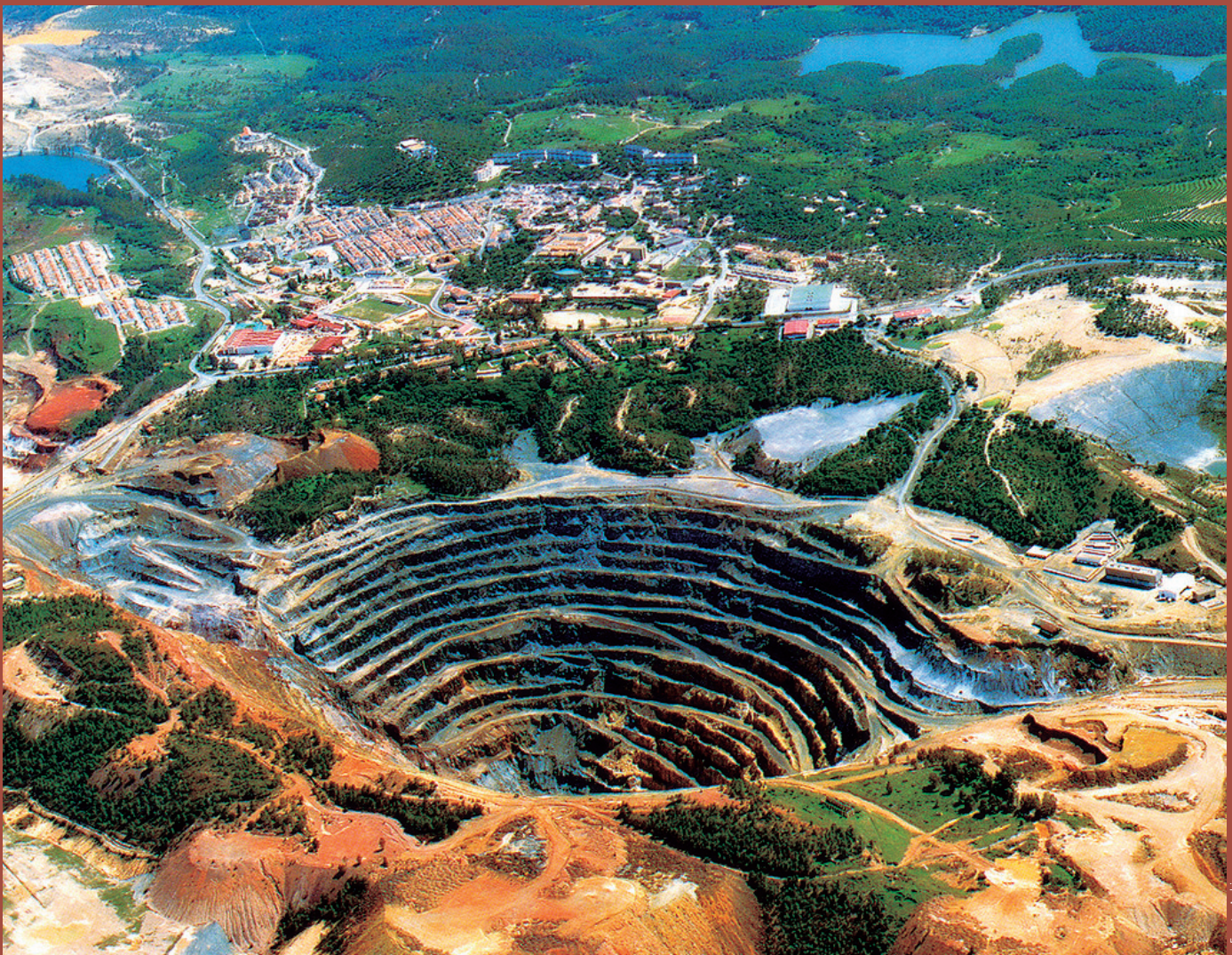
Se trata de un modelo de explotación minera que tiene como técnica principal el “tajo a cielo abierto”.
